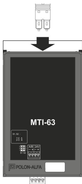
Rys. 23.8.3/1 Moduł MTI-63 – wtyczka typu SC
