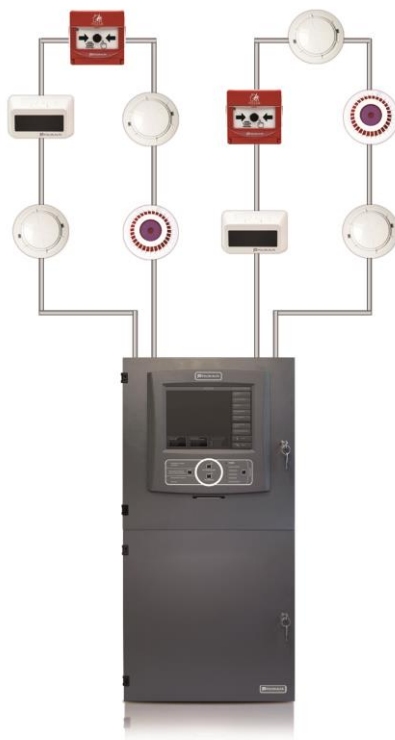
Rys. 2.2/1 Przykładowa konfiguracja sytemu POLON 6000 w architekturze nirozproszonej (tradycyjnej)
